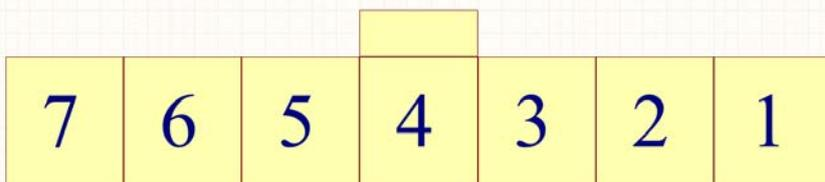
**Шина DATA может находиться на 2,3,5 или 6 контакте семи проводного разъема блока штатного иммобилайзера на рулевой колонке в зависимости модели автомобиля.**
