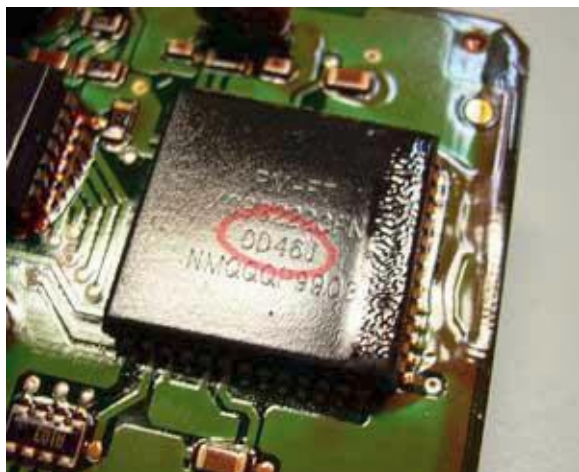
Расположения маркировки (маски) на корпусе процессора
